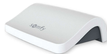
Fig. 3. Connexon box möjliggör för app-styrning (tillval)
